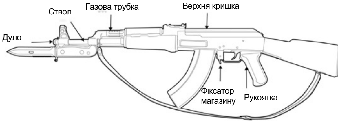
Рис. 1. Автомат АК-47. Вигляд зліва
