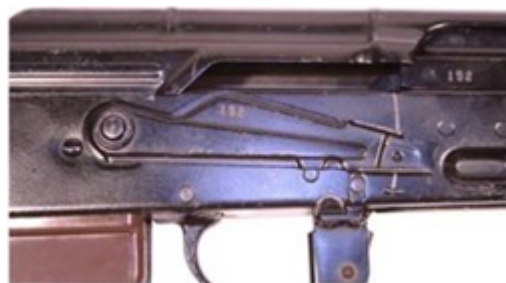
Рис. 8. Важіль перемикача в позиції АВТОМАТ
