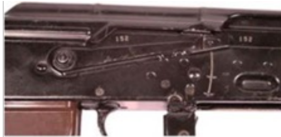
Рис. 6. Важіль перемикача в позиції ЗАПОБІЖНИК
