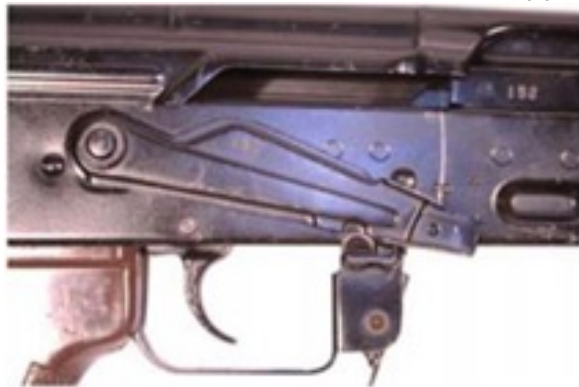
Рис. 7. Важіль перемикача в позиції НАПІВАВТОМАТ
